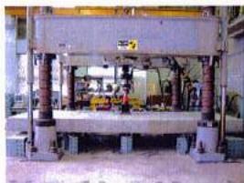
荷重分配試験状況 (中央載荷)
