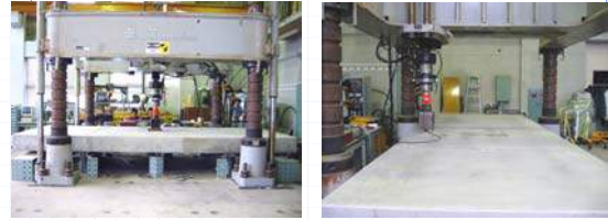
荷重分配試験状況 (中央載荷)
