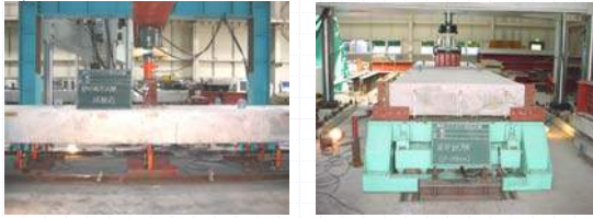
静的破壊試験状況
